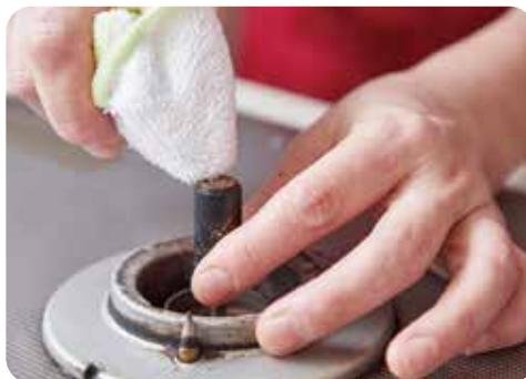
センサーの頭部・側面の汚れは、水に浸して固くしぼった布で、片手を添えて拭き取る。
